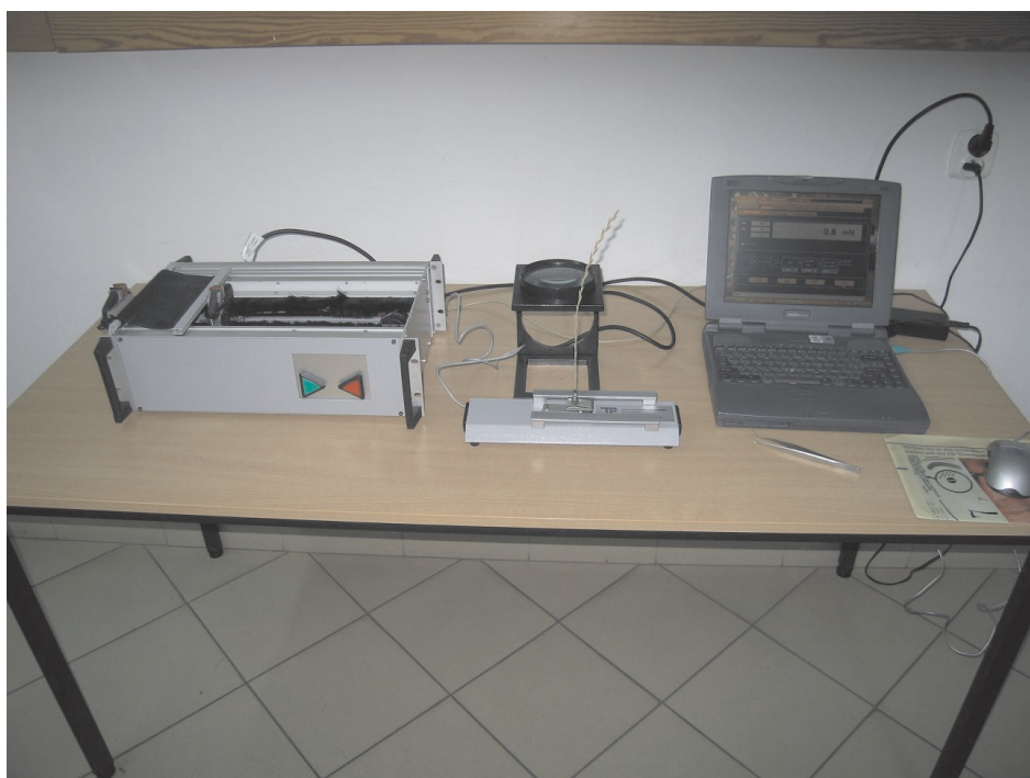
Fot. 1. Stanowisko pomiarowe do mierzenia wytrzymałości na zerwanie materiału roślinnego Phot. 1. The measuring stand for estimation of tensile strength of plant material
